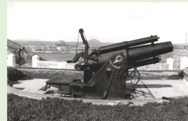
Imagen de un Obús de Hierro Sunchado de 24 cm Ordoñez mod 1906 de la Bateria N° 1 de Fajardo. Este material fue poco profuso en los artillados españoles coincidiendo con el ocaso de la eficacia táctica de los obuses.
