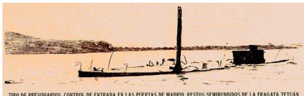
Figura 20. Restos de la fragata protegida Tetuán , hundida frente al muelle cartagenero de La Curra en la noche del 30 de diciembre de 1873, tras un incendio y posterior explosión en su pañol de municiones. (Grabado de la prensa francesa de la época).
